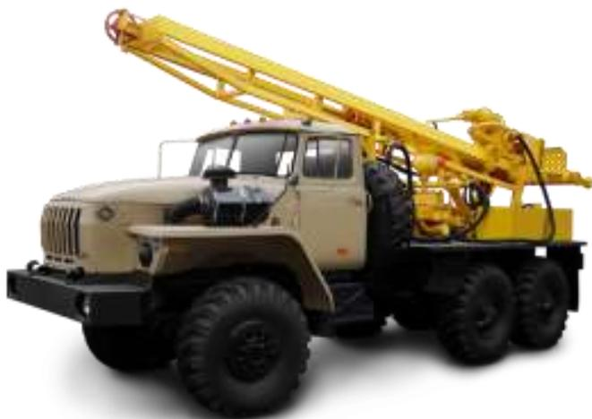
Предназначена для бурения вращательным способом с промывкой, продувкой, ударно-вращательным способом погружным пневмоударником и шнеками скважин различного назначения, в том числе водозаборных.
